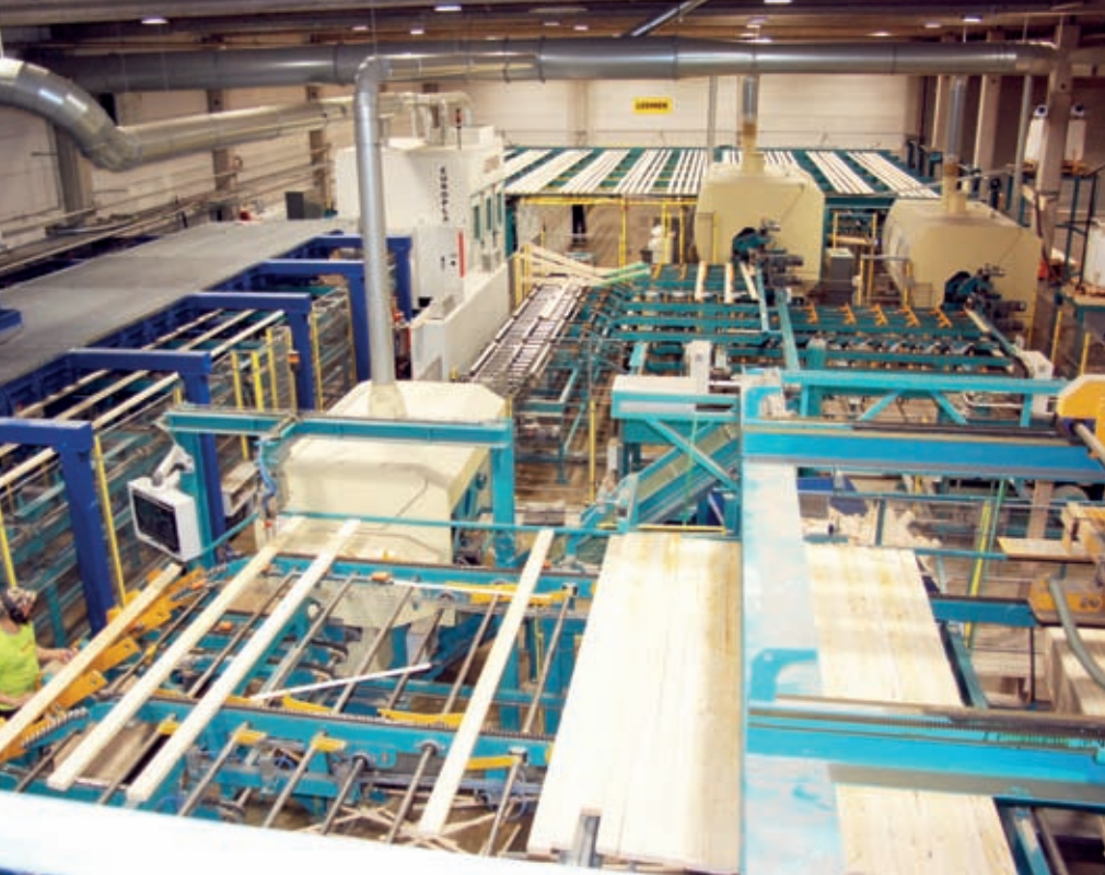
▲ Sormijatkostehtaan koneet ovat Ledinekin. Vasemmalla näkyy sininen Sepa Oy:n itse suunnittelema ja rakentama liimauskone, minkä avulla yritys pystyy tuottamaan syrjäliimattua palkkia.
