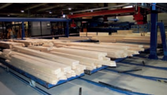
▲ Kaksi CNC-ohjattua sahalinjaa sahaa valmiiksi kattoristikoiden osia, jotka varastoautomaatti varastoi odottamaan kokoonpanoa.
